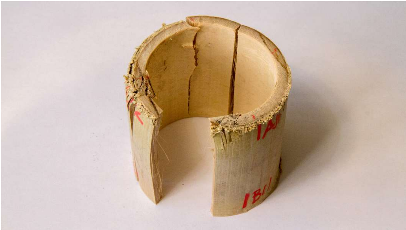
Fig.2 Un provino dopo la prova di compressione
