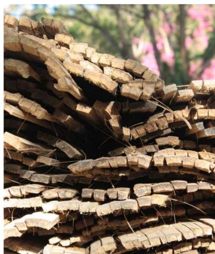
Fig.3 Lamelle di bambù per il semilavorato esterilla
