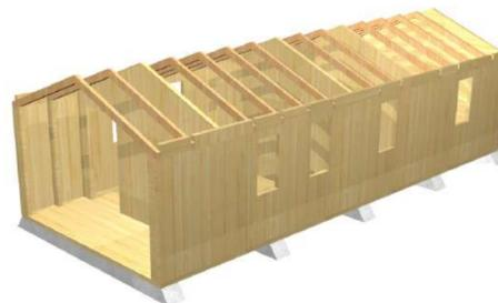
Fig.5 Struttura portante in X-LAM di bambù e travi in bambù lamellare
