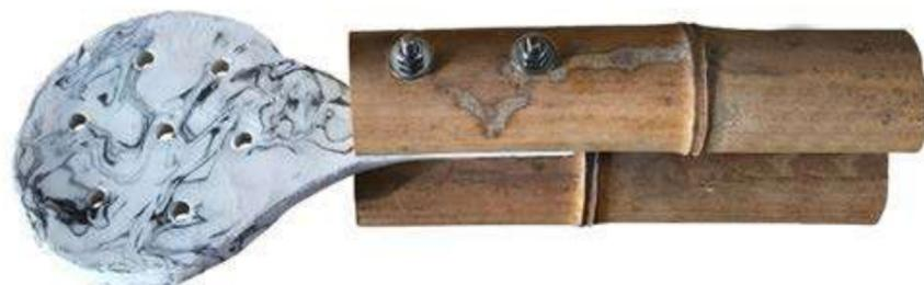
Fig.2 Dettaglio del collegamento tra l'elemento in plastica e il culmo
