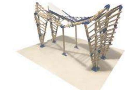
Fig.7 Immagine renderizzata del modulo strutturale
