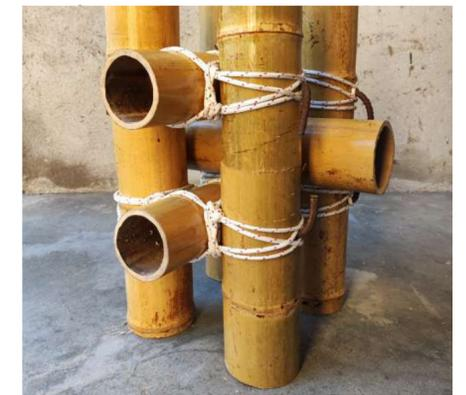
Fig.3 Prototipo del nodo
