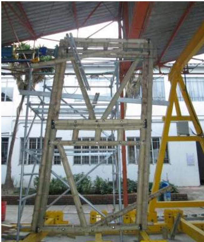
Fig.4 Prototipo tipo B sottoposto a carico orizzontale
