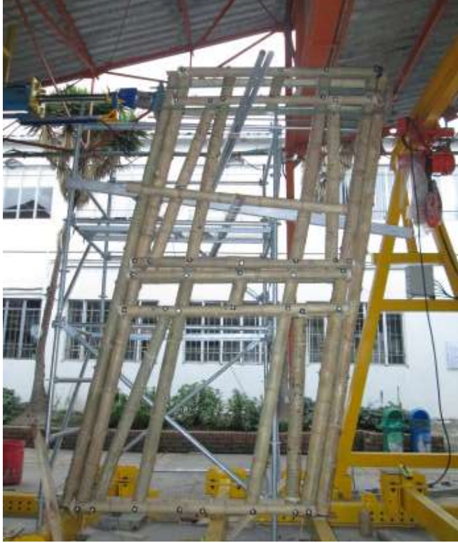
Fig.5 Prototipo tipo C sottoposto a carico orizzontale
